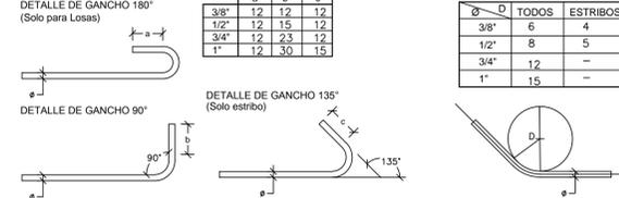
**5 DIAMETRO MIN. DE CURVATURA**
